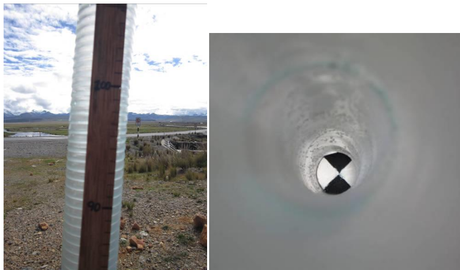
Fotografía N° 7: Medición de la transparencia del espejo de agua de la laguna Conococha
