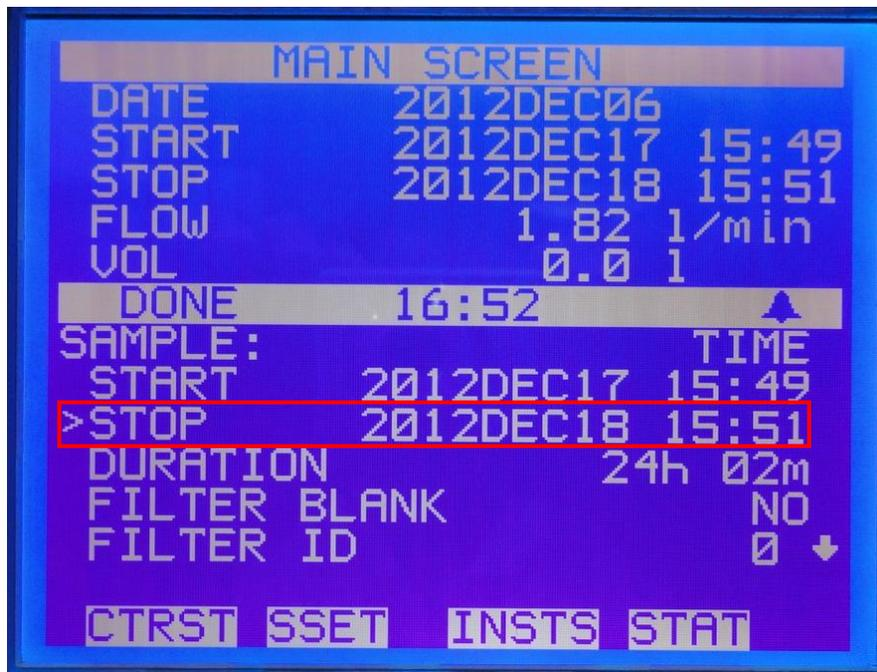
Luego que se muestre la pantalla presionar nuevamente "ENTER" para insertar la fecha y la hora de termino del muestreo.
