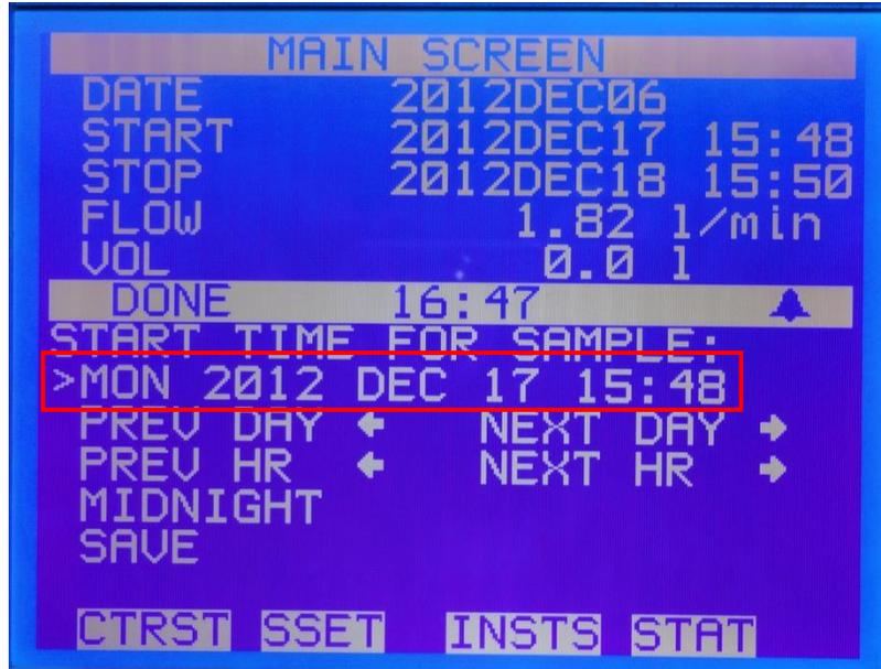
A continuación presionar "ENTER" y se procede a realizar los cambios de las fechas y horas como se muestra en la siguiente imagen (esto con la ayuda de las teclas direccionales).
