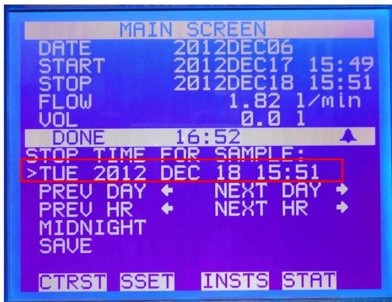
A continuación presionar "ENTER" y se procede a realizar los cambios de las fechas y horas de la finalización del muestreo (esto con la ayuda de las teclas direccionales).
