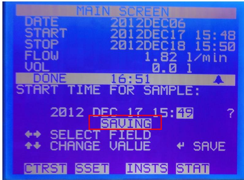
Antes de programar la fecha de finalizacion de muestreo se procede a salir del comando usando la siguiente tecla (presionar dos veces) para visualizar el comando "STOP"
