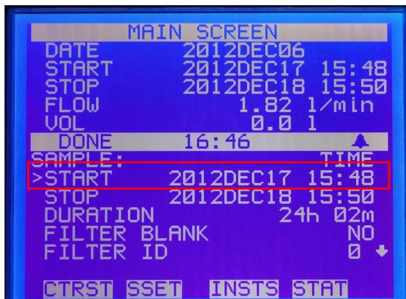
Luego que se muestre la pantalla presionar nuevamente "ENTER" para insertar la fecha y la hora de inicio del muestreo que se quiera realizar.
