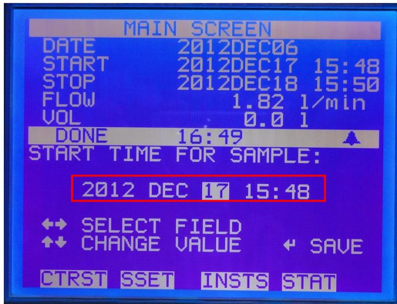
Una vez insertado la fecha y la hora se presiona "ENTER" para guardar los nuevos datos de inicio de muestreo. El cual aparece el aviso "SAVING" para indicar que los nuevos datos se estan guardando.
