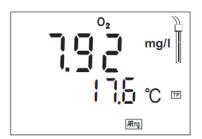
7.2.4.8 Manteniendo oprimida la tecla <RUN/ENTER> activar con <▲ > la corrección del contenido de sal. En el display aparece la indicación SAL. La función toma en cuenta el contenido en sal al efectuar la medición.
